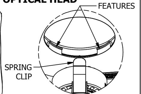
**NOTE: FOR ROUND TRIMLESS STYLES ENSURE SPRING CLIPS ARE ALIGNED BETWEEN FEATURES**
