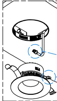
CONNECT THE OPTICAL HEAD HARNESS TO THE FRAME HARNESS.
