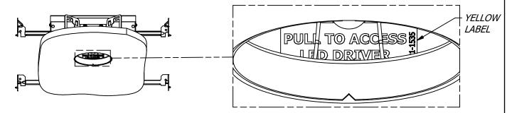
PULL THE CLIP TO OPEN THE LED DRIVER COMPARTMENT DOOR.
