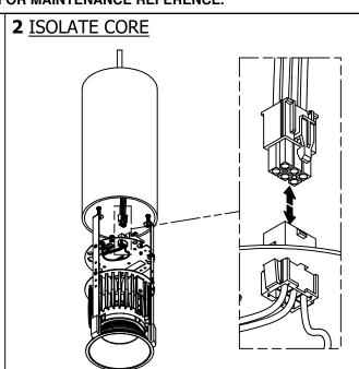
UNDO ELECTRICAL CONNECTION WHILE SUPPORTING CORE
